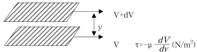
– surface viscosity : 평면상에서 서로 다른 속도로 움직이는 line(or wire)간에 미치는 힘.
