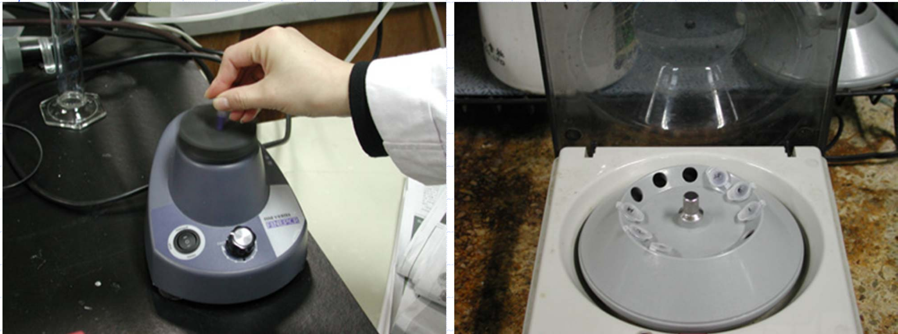
Fig.9. Vortex mixer로 혼합.(L), Centrifuge(R) .
