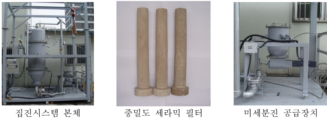
Fig. 2 Pilot급 집진장치 및 주변 기기 모습
