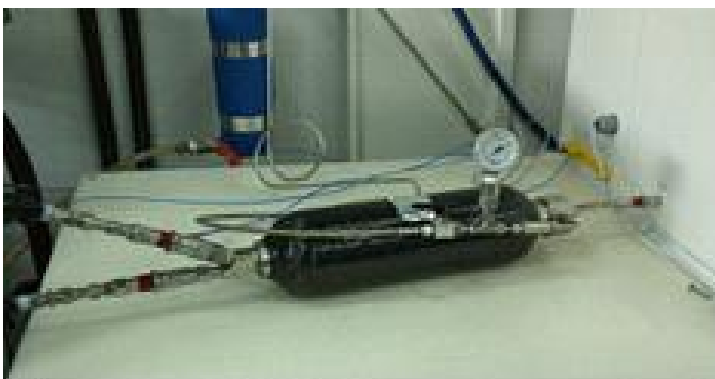
[사진 1] 프론티어사업을 통해 개발된 수소저장합금 기반 수소 100g급 저장시스템.
