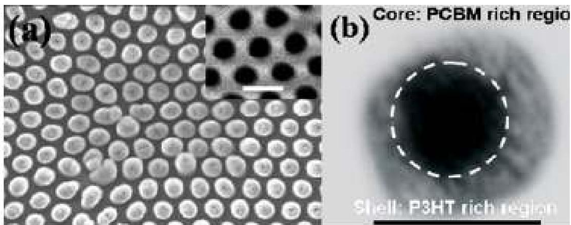
65nm 다공성 AAO 구조를 이용하여 효율(Power conversion efficiency): 2.0 % OSC 제작.
