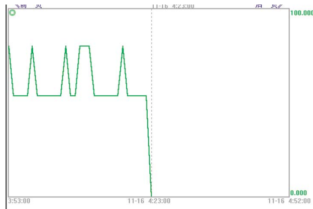
그림 4. 측정장치의 고장으로 인한 총계오차발생
