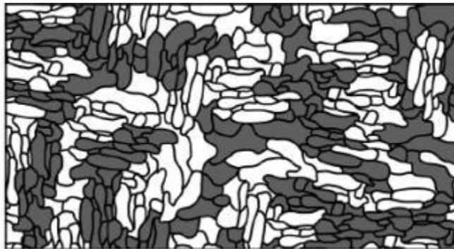
[그림 1] 이온-전자 혼합 전도성을 나타내는 MIEC 전도체 모식도
