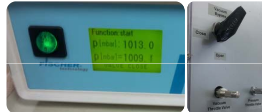
Control valve와 Control box를 이용하여 설정한 압력
