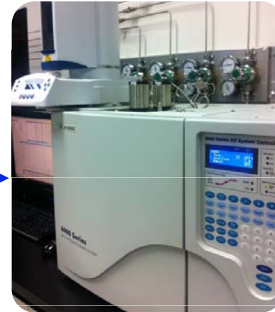
채취한 Sample의 GC 정량분석 및 농도 확인
