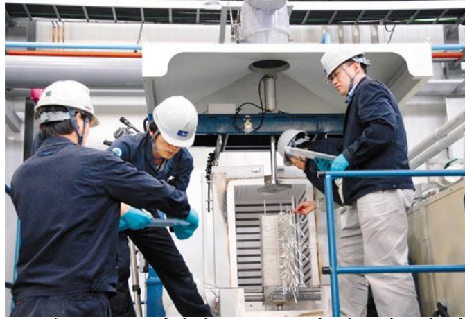
[그림] 5kW급 평판형 SOFC 스택 시스템조립 과정
