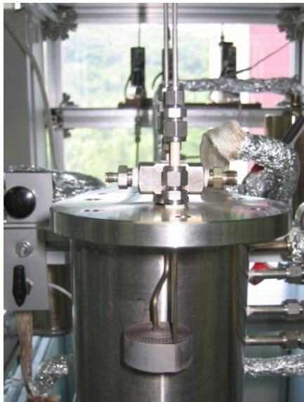
[그림] APU용 디젤 pre-reformer
