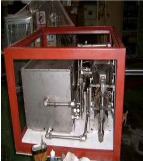
[그림] APU용 SOFC 발전시스템
